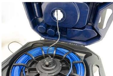
Fig. 60: Error: El cable de la cámara no se tira recto.
