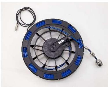
Fig. 56: Viper sacada de la maleta, el enchufe del monitor cubierto por una tapa
