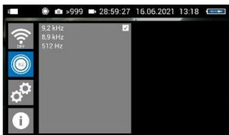
Fig. 32: Detección del localizador con la frecuencia de transmisión de 9,2 kHz seleccionada
